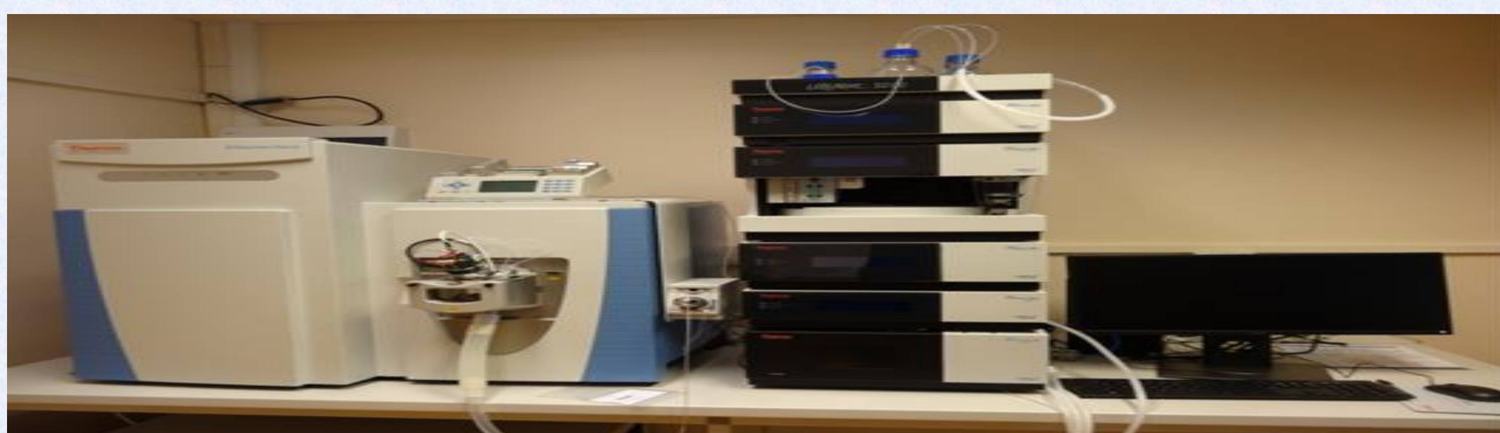
Wykorzystany do badań chromatograf ciekowy Dionex Ultimate 3000 (Thermo Scientific) sprzężony ze spektrometrem mas Orbitrap Q-Exactive Focus i detektorem wyładowań koronowych (CAD)
