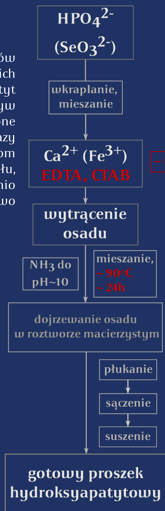
Rys. 1. Schemat procesu syntezy proszków (kolor czerwony – różnice w metodzie z dodatkiem surfaktantu).
